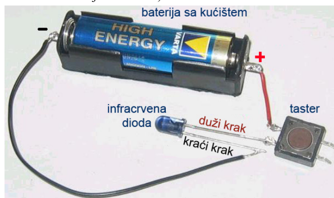
Slika 4: Elementi potrebni za formiranje strujnog kola infracrvene olovke
